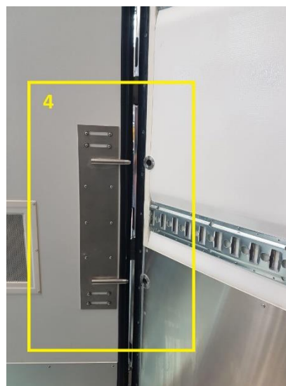
Fot. 2 i 4: Prawe skrzydło drzwi naczepy z zamontowanym zamkiem SBS InLock Pro (1a/1b) i wspornik anywyważeniowy drzwi z otworem na bolec w bocznej ścianie naczepy - Hing-Pin (2).
