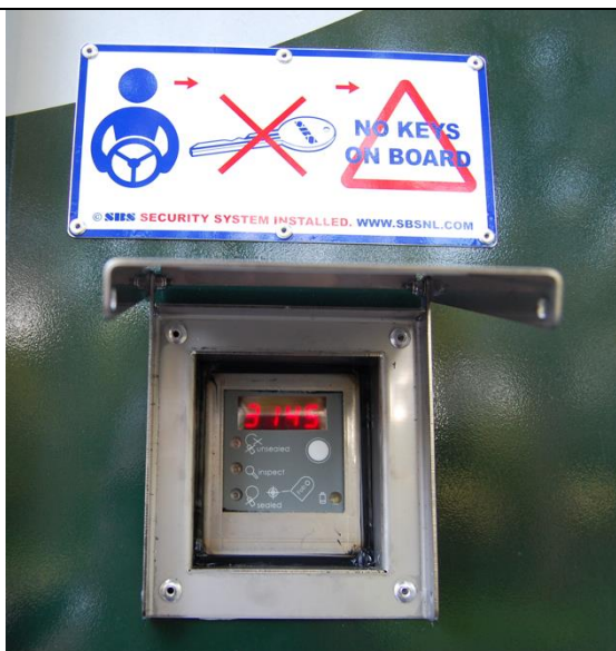
Fot. 6: Panel systemu kontroli dostępu Seal IQ z wyświetlaczem, na którym widoczny jest 4-cyfrowy kod plomby. Blokadę można zwolnić, wprowadzając kod PIN białym przyciskiem lub za pomocą transpondera RFID.
