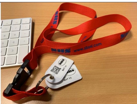
Fot. 7: Transponder RFID lub brelok można zaprogramować w bazie zarządzania kluczami dostępnej w aplikacji internetowej użytkownika, aby umożliwić otwieranie pojedynczych pojazdów lub uzyskać dostęp do całej floty. Brelok zgubiony można zastąpić nowym po uprzednim usunięciu zgubionej sztuki z systemu.
