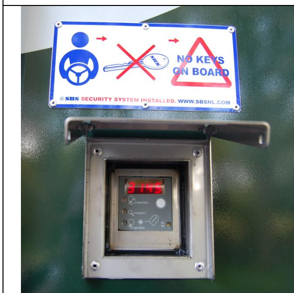
Fot. 5: Panel systemu kontroli dostępu Seal IQ z wyświetlaczem, na którym widoczny jest 4-cyfrowy kod plomby. Blokadę można zwolnić, wprowadzając kod PIN białym przyciskiem lub za pomocą transpondera RFID.
