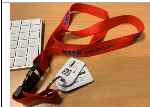
Fot. 6: Transponder RFID lub brelok można zaprogramować w bazie zarządzania kluczami dostępnej w aplikacji internetowej użytkownika, aby umożliwić otwieranie pojedynczych pojazdów lub uzyskać dostęp do całej floty. Brelok zgubiony można zastąpić nowym po uprzednim usunięciu zgubionej sztuki z systemu.
